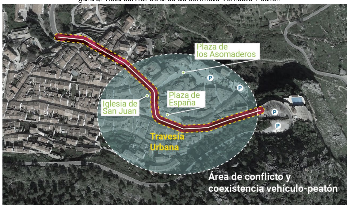
Figura 4. Vista cenital de área de conflicto Vehículo-Peaton
