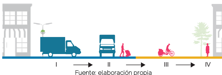
Figura 24. Esquema de funcionamiento de micro plataforma de distribución
